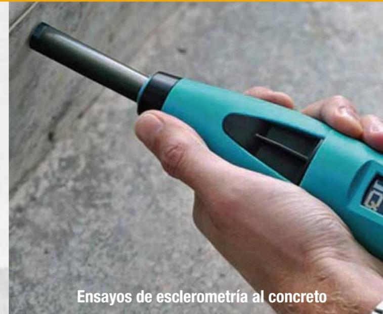
Ensayos de esclerometría al concreto
